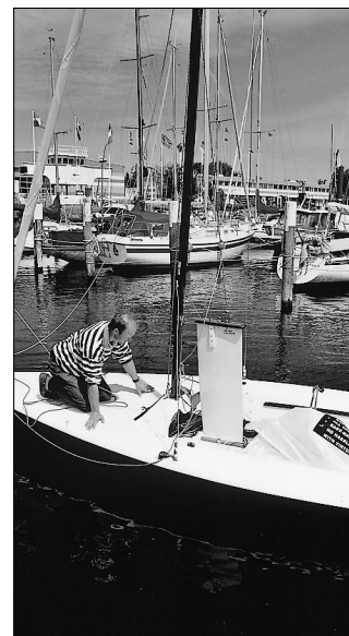
Das Kiel-Schwert läßt sich über 1:20 Übersetzung unter der Saling schnell für den Transport heben oder fieren
